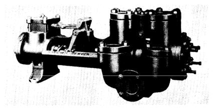
b. DIVIDED FLUID-CYLINDER VALVE-POT-TYPE PUMP
